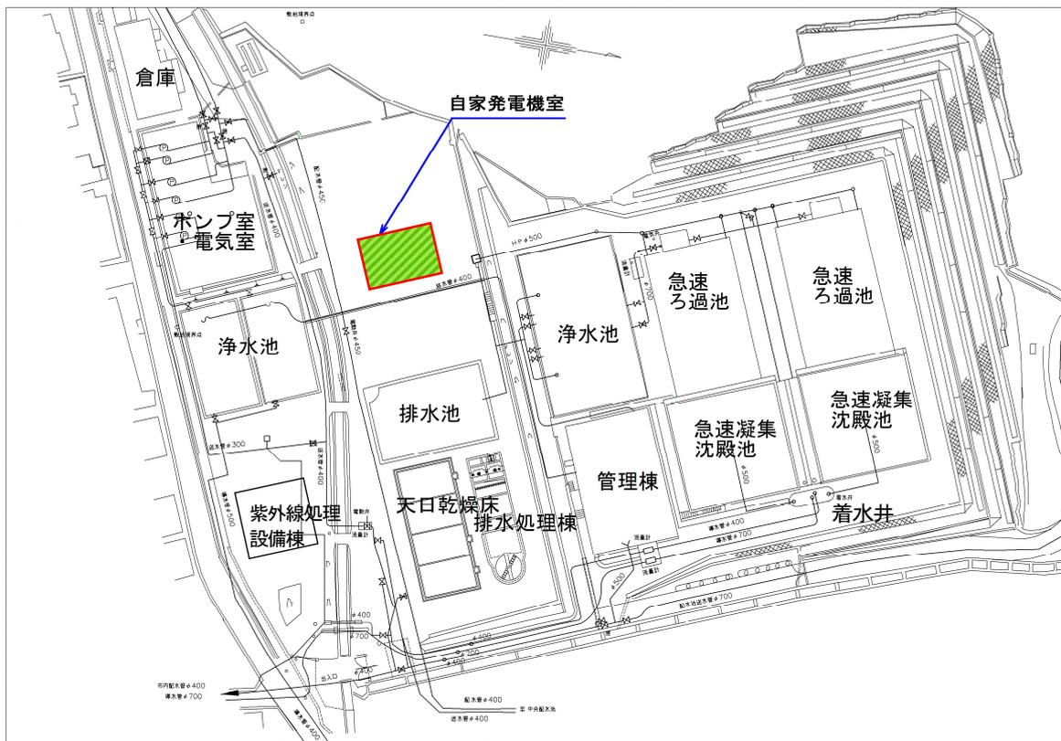
図 6-19 北野中浄水場 自家発電機室位置図
