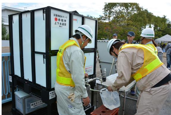
写真6-14 災害用組立式タンク 1.0m<sup>3</sup>
