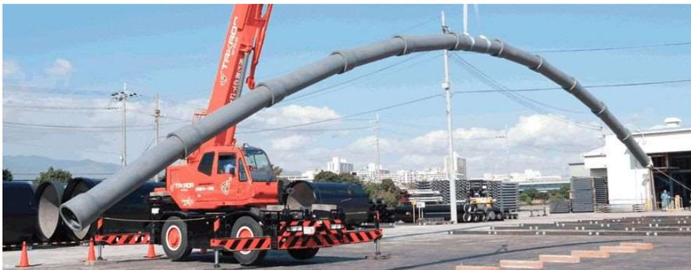
写真 6-8 耐震管の例（ダクタイル鋳鉄管 GX 形継手）
