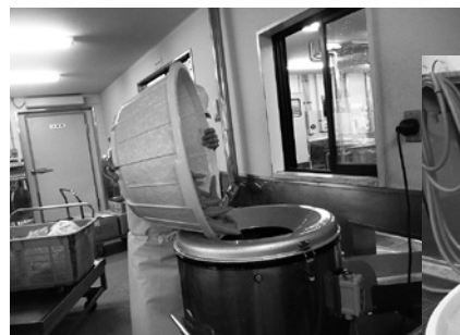
きゅうこんかわ球 根皮むき機で、洗いながら皮をむきます。
