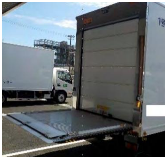
写真 3-2 リフト式給食配送車両
